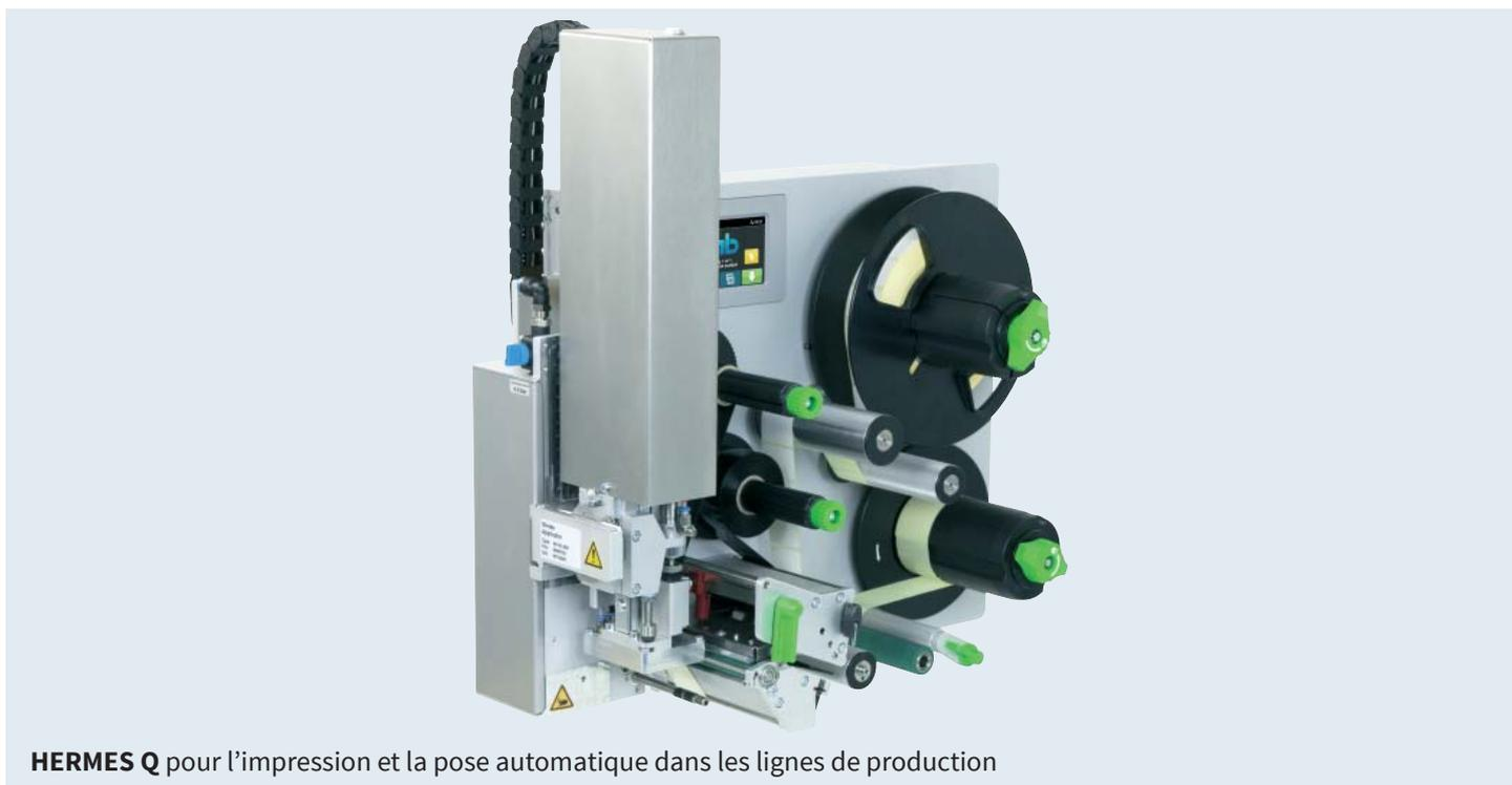
HERMES Q pour l'impression et la pose automatique dans les lignes de production
