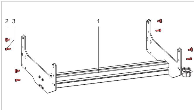
Le cintre de fixation est un élément de montage permettant d'intégrer une imprimante Hermes C de façon suspendue dans une ligne de production.
