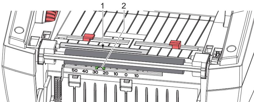
圖 16 定位反射式感測器
