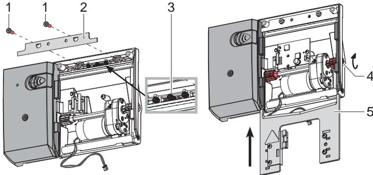
1. Messerbalken (2) aufsetzen und dabei darauf achten, dass die Druckfedern (3) nicht geknickt werden und in den Führungen bleiben.
