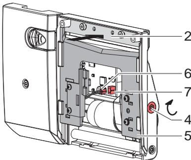
4. Messerbalken (2) nach innen drücken und durch Drehen der Achse (4) in Uhrzeigerichtung die Klinge (5) über den Messerbalken (2) bis ganz nach oben schieben.
