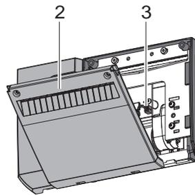
2. Schrauben (1) lösen und Abdeckung (2) nach vorn herausnehmen.
