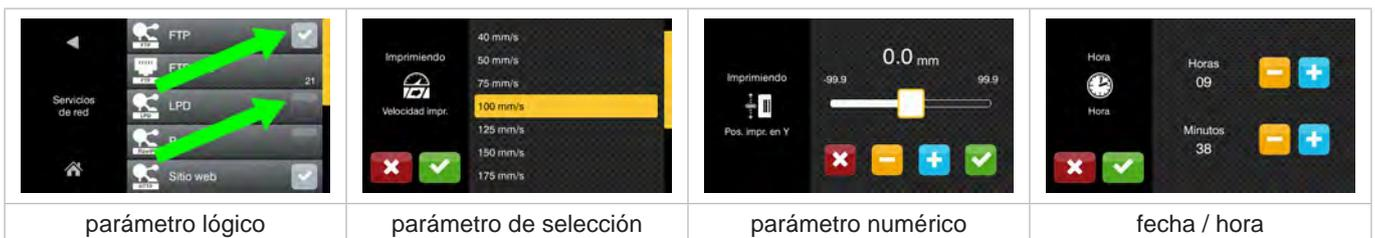
Figura 10 Ejemplos de ajuste de parámetros
