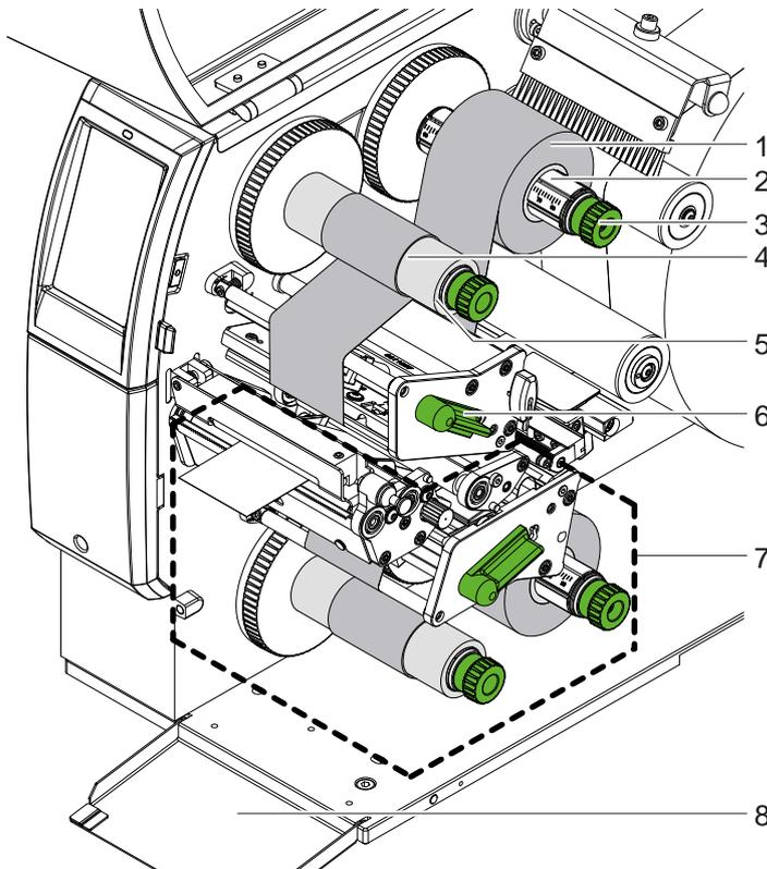
Bild 17 Transferfolie einlegen
