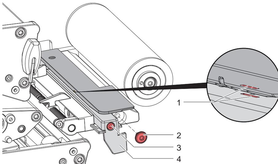
Bild 21 Etikettenlichtschanke reinigen
