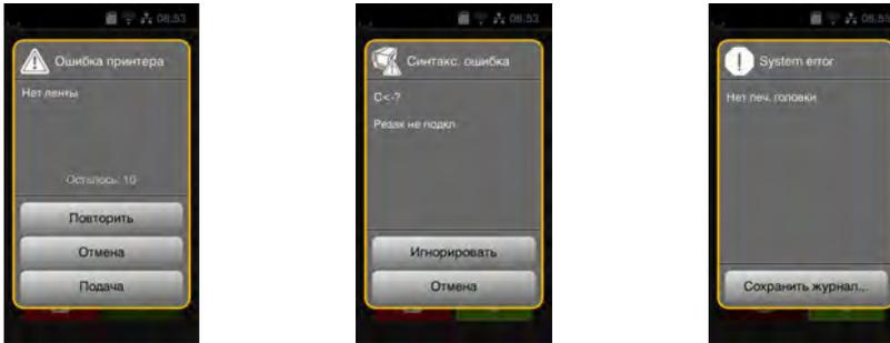
Рис. 22 Индикация неисправностей/ошибок
