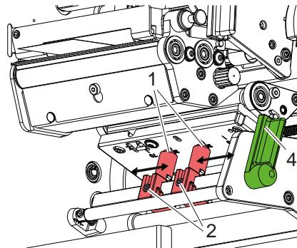
图 16 调整下打印头压紧系统
