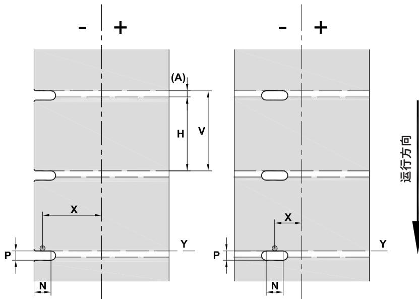
图 26 冲孔尺寸
