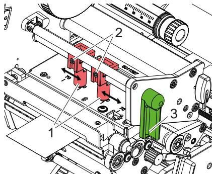
图 15 调整上打印头压紧系统
